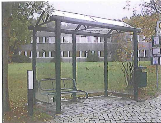
[6] Wartehalle Modell Zürich Z 800 3.000 x 1.500 x 2.200 mm (lichte Höhe) ✓ 3.400 x 1.660 mm (Dachabmessung) Giebel in Längsausrichtung (RAL 6005) Zubehör: Sitzbank U-210, Abfallbehälter.
